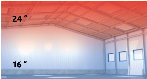
Wärmeverteilung ohne Wärmerückführung
