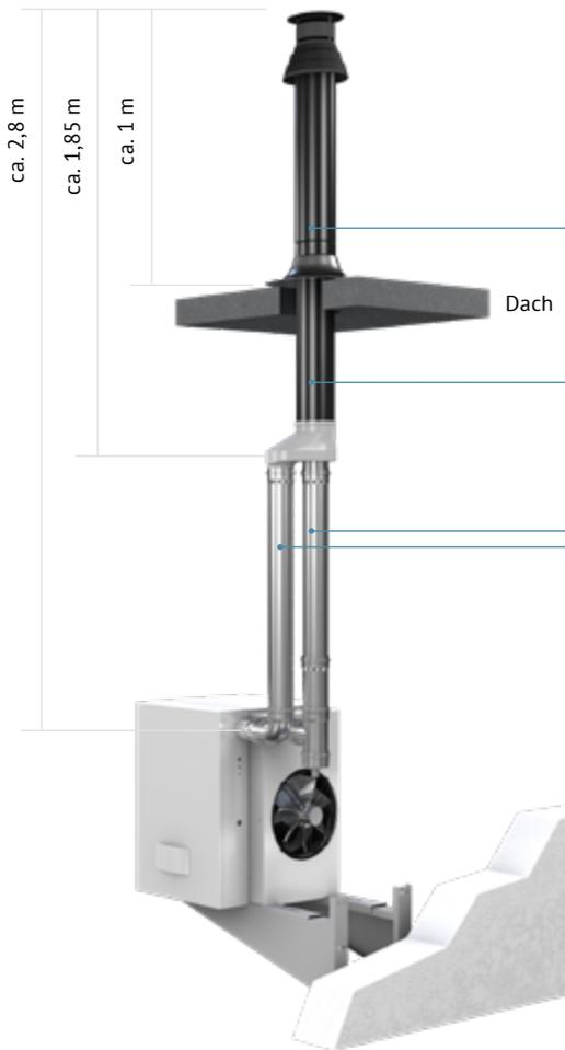
Der LAS-Grundbausatz (Pos. 1-9, siehe Seite 14) setzt sich aus den dargestellten Komponenten zusammen und hat eine Länge von 2,8 m. Sollte eine andere Länge erforderlich sein, so kann die LAS-Abgasführung durch drei Optionen (A,B oder C) verlängert werden:
