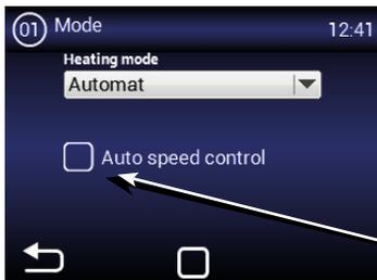
Aktivierung/Deaktivierung der automatischen Steuerung der Drehzahl der Motoren nach den Temperaturen
