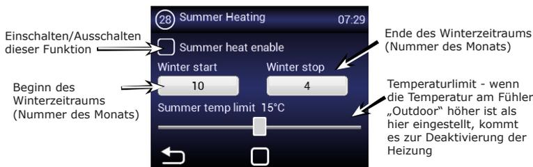
Wenn kein Fühler für die Außentemperatur eingestellt ist, arbeitet das Regime „summer heating“ nur entsprechend dem eingestellten Zeitraum und die Außentemperatur wird nicht ausgewertet
