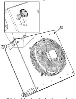
3) Die Heizeinheit auf die Halter aufsetzen und einschrauben.
