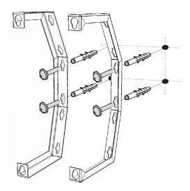
2) Obere Schrauben in den Erhitzer einschrauben und eine Lücke zum Einschieben von Halter frei lassen (ca. 1 Drittel der Schraubenlänge).
