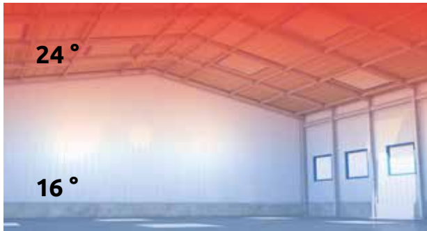
Wärmeverteilung ohne Wärmerückführung
