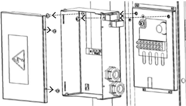
**2) Demontieren Sie die Abdeckung des Schützmoduls**
