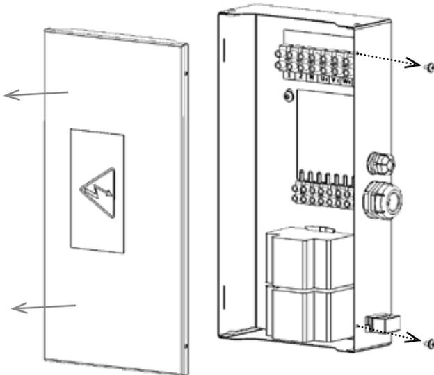
**3) Setzen Sie das Schützmodul auf die Klemmleiste und befestigen Sie es mit Hilfe von Schrauben. Ziehen Sie die gesamte Klemmleiste ordnungsgemäß an.**
