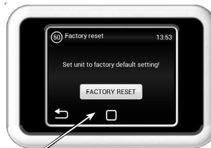
Nach dem Drücken der FACTORY-RESET-TASTE startet die Einheit mit den Werkparametern.
