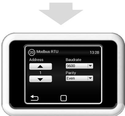
Das Menü MODBUS RTU dient zur Einstellung der Modbus-Kommunikation.
