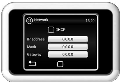
Das Menü NETWORK dient für die Einstellung der Netzkommunikationseinheit (ModBus TCP)
