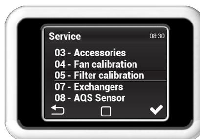
Die Kalibrierung muss vor der ersten Inbetriebnahme und nach jedem Filterwechsel erfolgen.
