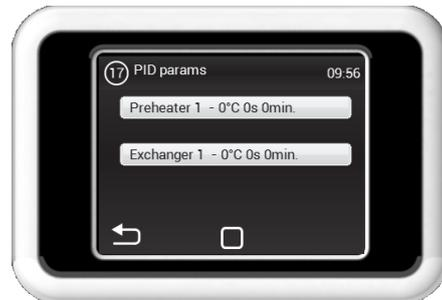
Einstellung der Regulierungseigenschaften. Falls die Regulierung nicht dauerhaft oder veränderlich ist, kann diese Einstellung über eine Absprache mit dem Hersteller durchgeführt werden.
