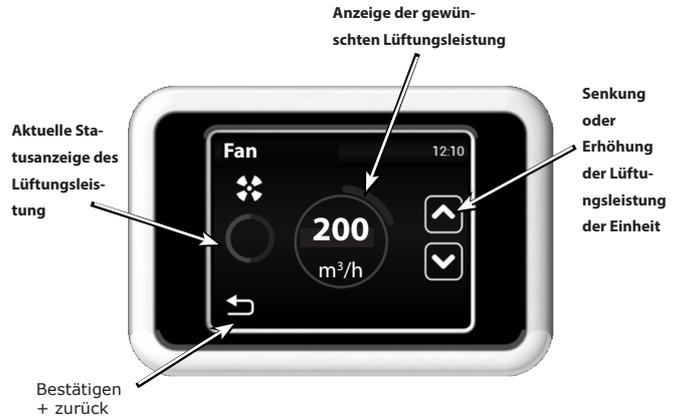
Anzeige der gewünschten Lüftungsleistung
