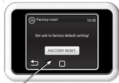
Nach dem Drücken der FACTORY-RESET-TASTE startet die Einheit mit den Werksparametern.
