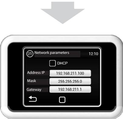
Das Menü NETWORK dient für die Einstellung der Netzkommunikationseinheit (ModBus TCP)
