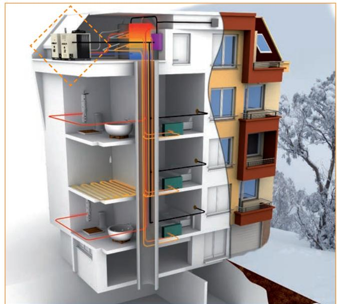
Anwendungsbeispiel bei Sommer- und Winterbetrieb von Anlagen mit Flächenheizsystemen, Gebläsekonvektoren, indirekte TWW-Produktion.
